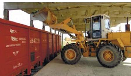
Нормативный расход топлива для универсального погрузчика определяется в зависимости от режима работы: планировка грунтов, погрузка грунтов, перемещение грузов, уборка снега, подметание, работа стрелой, транспортный режим. Установленные нормы в зависимости от вида работ составляют от 7 до 11,2 литров на машинно-час, т.е. могут отличаться в 1,5 раза.
